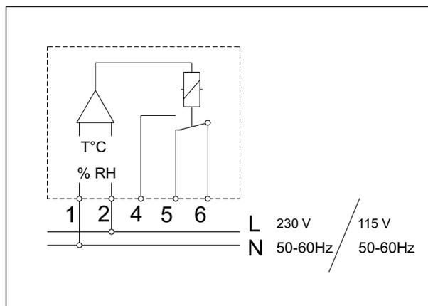
Il termogrostatato elettronico comanda, per mezzo di un relay, carichi induttivi o resistivi al fine di mantenere nell'armadio i valori impostati di temperatura e umidità.
