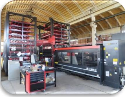
Macchinari con controllo automatico dei parametri di taglio, potenza e forma d'onda del laser, tipo e pressione dei gas di assistenza, distanza tra ugello e materiale, con interfaccia grafica interattiva "on line".
