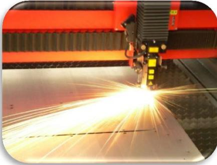
Maschinen mit automatischer Steuerung der Schneidparameter. Leistung der Laserwellenform , Art und Druck der Hilfsgase , Abstand zwischen der Düse und dem Material mit grafischer Benutzer Oberfläche "on line". Mitnahme der Leistung und der Wellenform mit der gleichen Geschwindigkeit des Werkzeuges. Automatische Erkennung vom Typ des
