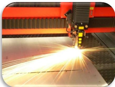
この機器は切断パラメータ、レーザーの波の力と形、アシスト・ガスの種類と圧力、ノズルから素材までの距離の自動制御がある。この自動制御は対話的オンライン・グラフィック・インターフェースを使っている。その上、機器は次の特徴もある。波の
