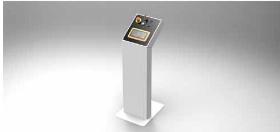
Il pulpito è realizzato in lamiera verniciata a polveri epossidiche e secondo standard qualitativi elevati. Per soddisfare al meglio le esigenze del cliente forniamo il pulpito con il pannello forato a disegno già predisposto al cablaggio, oppure lo equipaggiamo con un pannello in alluminio di spessore 2mm per facilitare il cliente in un'eventuale lavoro di foratura.
