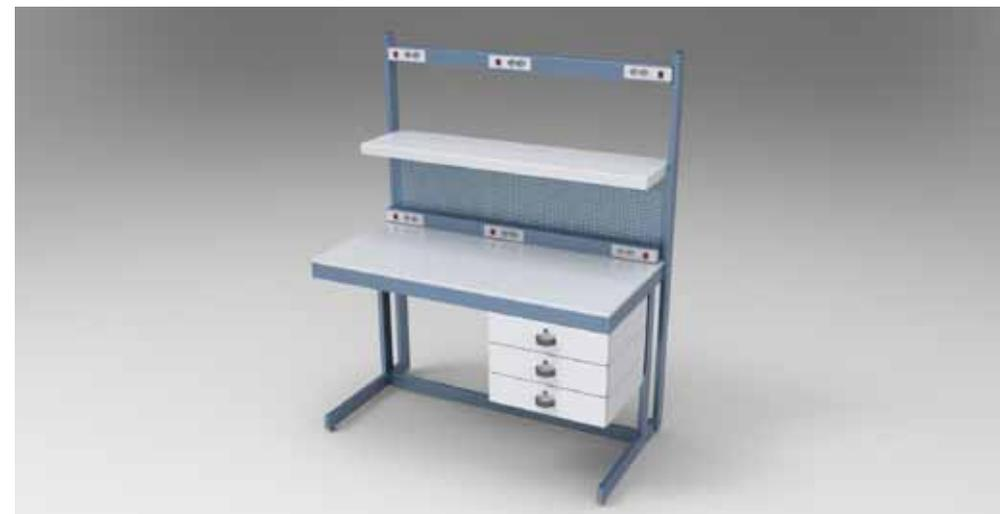
La postazione di lavoro presenta dodici prese di alimentazione da 220 volt, raggruppate a due a due e munite di interruttore luminoso. La mensola ha un'altezza di 30 mm ed è fissata a due montanti. Questi ultimi, oltre a mantenere rigida la struttura e a reggere la mensola, vengono utilizzati per il fissaggio di una lastra forata.
