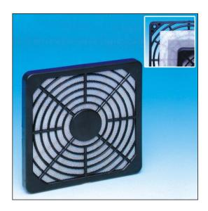
I kit filtro della serie "ALFAKR120" rappresentano una soluzione economica alla ventilazione dei quadri elettrici. Possono essere utilizzati singolarmente o accoppiati con un ventilatore di dimensione 120x120. Le parti plastiche sono realizzate in ABS UL94 V0 nero.
