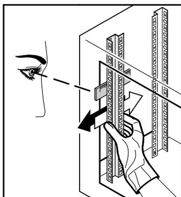
Per un miglior montaggio dei componenti ed accessori, le unità RACK sono dotate di foro di riferimento.
