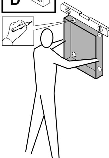
Forare con una punta da muro Ø 8.
