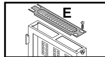
In base ai collegamenti da eseguire, aprire le finestre del kit posteriore per un miglior posizionamento dei cavi e fissarli con le fascette F.
