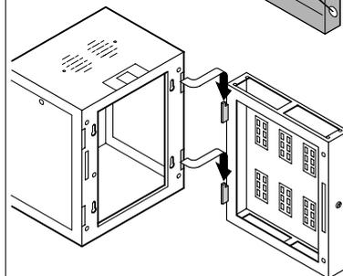
Per evitare l'introduzione di polvere nel kit posteriore si può montare il pannello para polvere E, fissandolo con le viti e dadi in dotazione.
