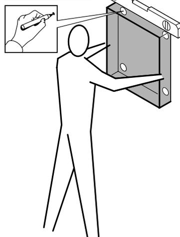
Forare con una punta da muro Ø 8.
