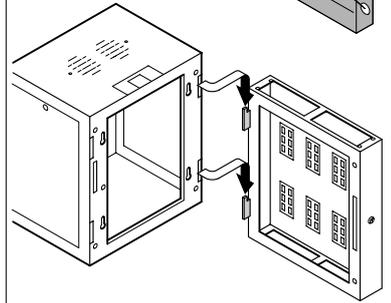
Per evitare l'introduzione di polvere nel kit posteriore si può montare il pannello para polvere E, fissandolo con le viti e dadi in dotazione.
