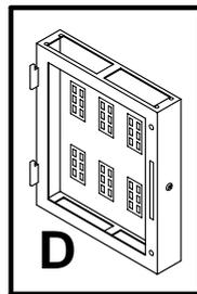
Posizionare contro il muro il kit posteriore e metterlo in bolla.
