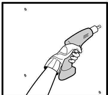
In base al peso che dovrà essere sostenuto e alle leggi da rispettare in materia, inserire nel muro quattro tasselli e fissare il kit posteriore con rondelle dentellate e viti.
